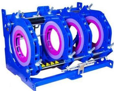
**Центратор**- предназначен для центрирования и выравнивания торцов труб и соединительных деталей. Состоит из стальной рамы, пары подвижных хомутов, приводимых в движение гидравлическими цилиндрами и пары неподвижных хомутов. Диаметр свариваемых труб от 450 мм до 710 мм (в стандартную комплектацию входят диаметры 450, 500, 560, 630, 710 мм)
