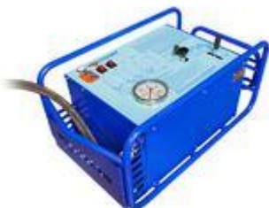
**Гидростанция с блоком управления** - предназначена для перемещения подвижной пары хомутов центратора и создания необходимого прижимного усилия на этапах сварочного процесса. Состоит из средств измерения и контроля давления, трехпозиционного распределителя потока, монтажной плиты и нагнетающей установки.
